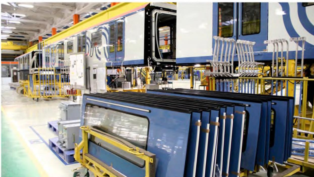
Рис. 2 Линия сборки вагонов, зоны размещения деталей и комплектов
